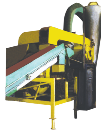
魚粉冷却機 (Cooling System)
